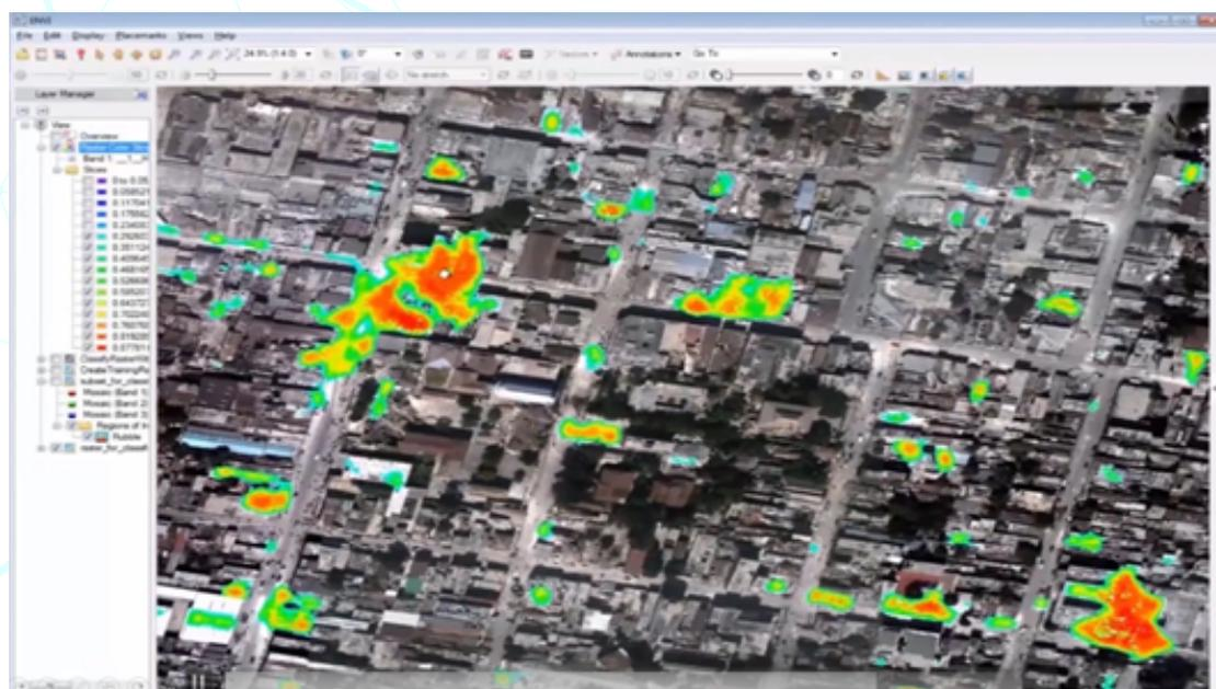
Figura 2: Identificación automática de escombros con el módulo Deep Learning.
