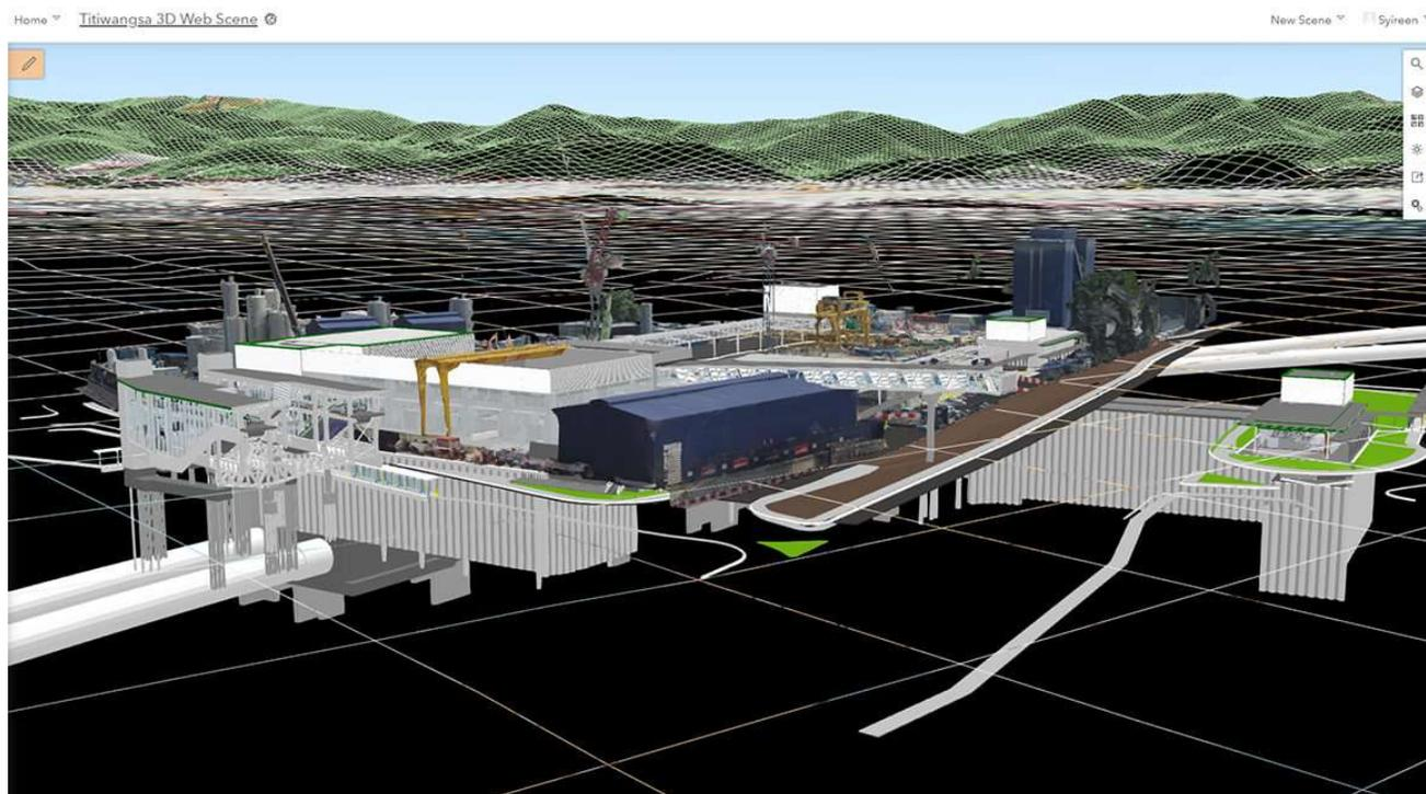
El portal de la Línea SSP unifica la información BIM del proyecto y los modelos de realidad que se crean mensualmente fusionando las fotos capturadas por un dron. Imagen: MRT Corp
