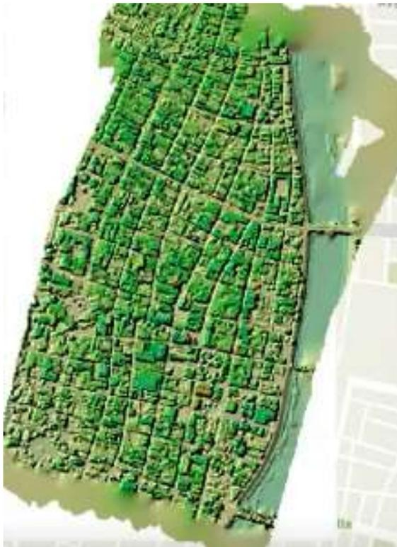
Imagen 2. Modelo de Superficie (DSM) de un área urbana
